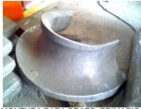
MONTURA PARA BRAZO, PRIMARIO (FUND. BLANCA ALTOCROMO)
