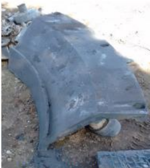
CORAZA ARANA PRIMARIO (ACERO MANGANESO)
