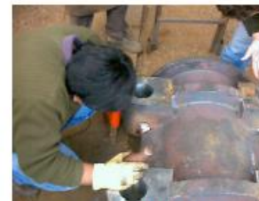
DESCANSO MOLINO (ACERO CARBONO ASTM A27)
