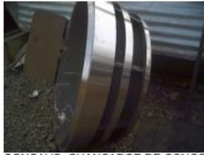
CONCAVO, CHANCADOR DE CONOS (ACERO MANGANESO)
