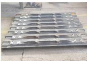
BANDEJA ALIMENTADOR (ACERO MANGANESO)
