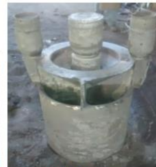
CRUCETA (ACERO CARBONO ASTM A27)
