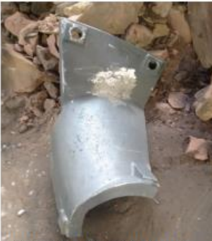
PROTECCION BRAZO PRIMARIO (FUND. BLANCA ALTOCROMO)
