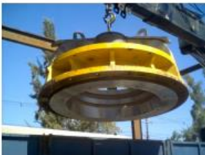
BASTIDOR SUPERIOR CHANCADOR (ACERO SAE 4340)
