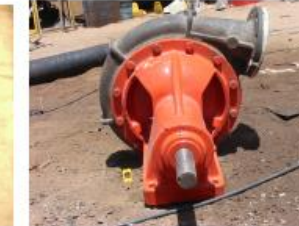
BOMBA INOXIDABLE PARA ÁCIDO (ACERO INOX. AISI 316)
