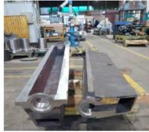
VIGUETAS (CAST IRON ASTM A-48)
