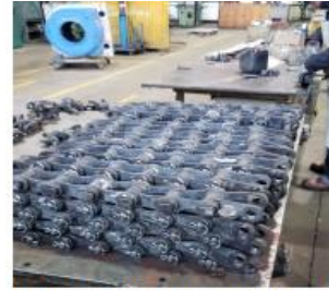
ESLABONES CADENA PARA HORNO (FUND NODULAR PERLITICA)
