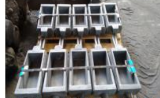
LINGOTERAS FUNDICION DE PLATA (FUND NODULAR PERLITICA)
